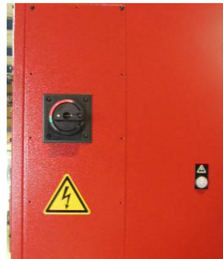
MACHINE CIRCUIT BREAKER SWITCH
